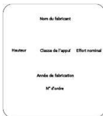
Figure 1 - Marquage sur poteau béton
